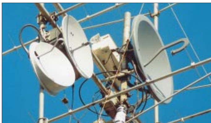
Ausschnitt aus der Antennenanlage von G3LQR im April 1995, rechts der 10-GHz-Spiegel mit sogenanntem Krückstockstrahler und direkt dahinter montiertem Transverter.
