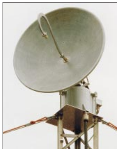
Ausschnitt aus der Antennenanlage von G3LQR im April 1995, rechts der 10-GHz-Spiegel mit sogenanntem Krückstockstrahler und direkt dahinter montiertem Transverter.
