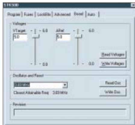
Bild 3: Sowohl die Betriebsspannung als auch die analoge Referenzspannung sind per Software einstellbar.
